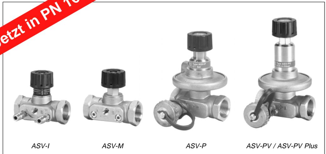
ASV Strangventile werden in Heizungs- und Kühlanlagen für einen automatischen, d.h. permanenten Abgleich von 0 bis 100 % Last, eingesetzt. Dieser Abgleich erfolgt durch eine Regelung des Differenzdruckes in Systemen mit variabler Durchflussmenge – ohne eine besondere Abgleichprozedur. So lässt sich bei allen Lastzuständen Energie einsparen. Automatische Strangventile sind ein wichtiger Bestandteil des in der VOB DIN 18380 für Heizungsanlagen geforderten hydraulischen Abgleichs.
