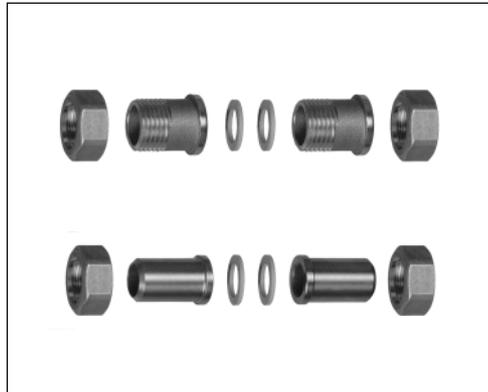
Für Ventile mit Außengewinde bietet Danfoss Gewinde- oder Schweißnippel als Zubehör an. Ein Nippel-Set besteht aus zwei Nippeln, zwei Überwurfmuttern und zwei Dichtungen.
