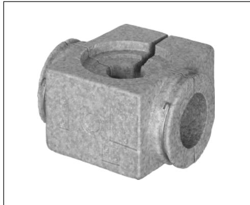
Die mit den Ventilen gelieferte Styroporverpackung kann in Anlagen, in denen die Temperatur bei Dauerbetrieb 80°C nicht überschreitet, als Isolierschale verwendet werden. Als Zubehör wird eine EPP Isolierschale für den Einsatz bei höheren Temperaturen bis 120°C angeboten. Beide Werkstoffe (EPS und EPP) entsprechen Baustoffklasse B2, DIN 4102.
